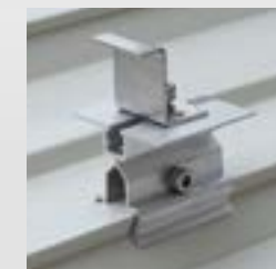
Staffa in alluminio di aggancio al pannello Solarpan Plus con fissaggio ZETA per moduli FV con cornice
