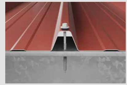
Fissaggio su metallo
